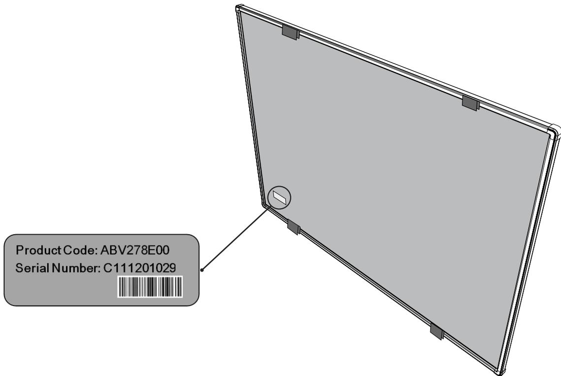
Die Beschriftung befindet sich an der Rückseite des ActivBoard, in der linken unteren Ecke.
